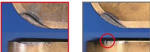
Microroturas tras 360 segundos de mecanizado
